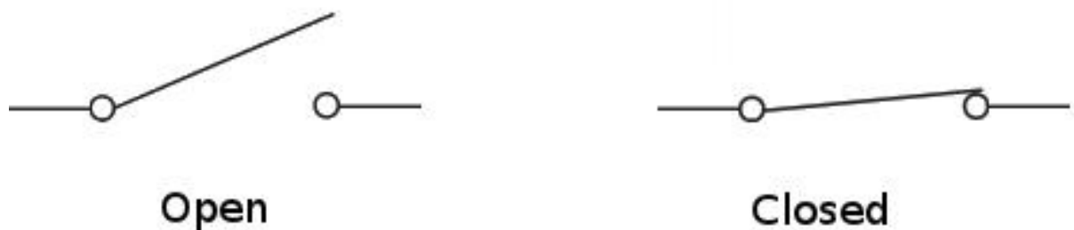
[그림 18] Switch의 open 상태 및 closed 상태.
