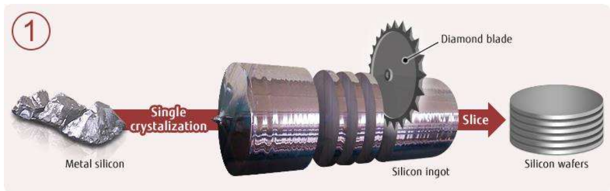
[그림 7] 결정질 실리콘 잉곳이 실리콘 웨이퍼로 제작되는 과정.
